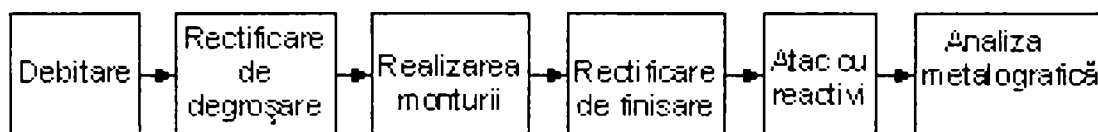
Fig.2.4. Itinerarul operațiilor metalografice
