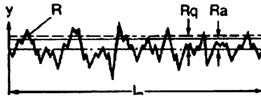
Figura IV-9: Reprezentarea schematică a rugozității medii Ra
