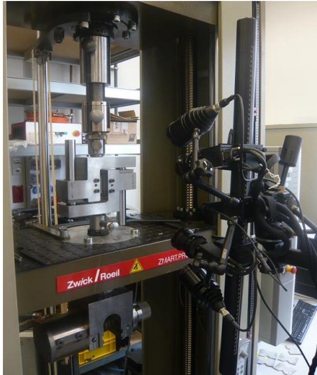
Figura 4.6.26 Măsuratori de întindere pentru determinarea modului de forfecare cu ajutorul ARAMIS
