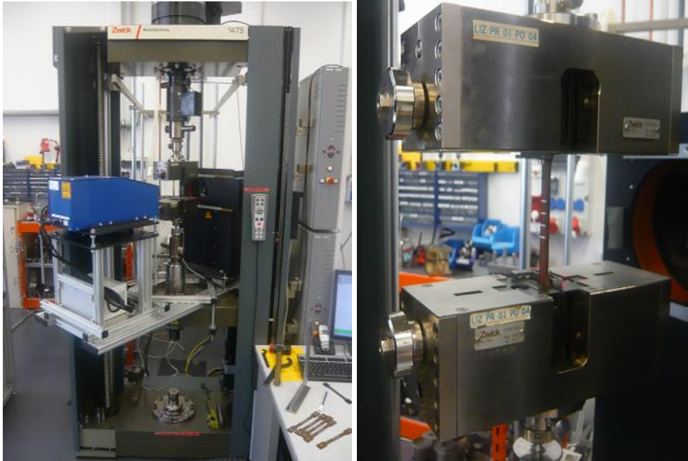
Figura 4.6.22 Configurația de testare pentru determinarea modului Young și raporturile lui Poisson
