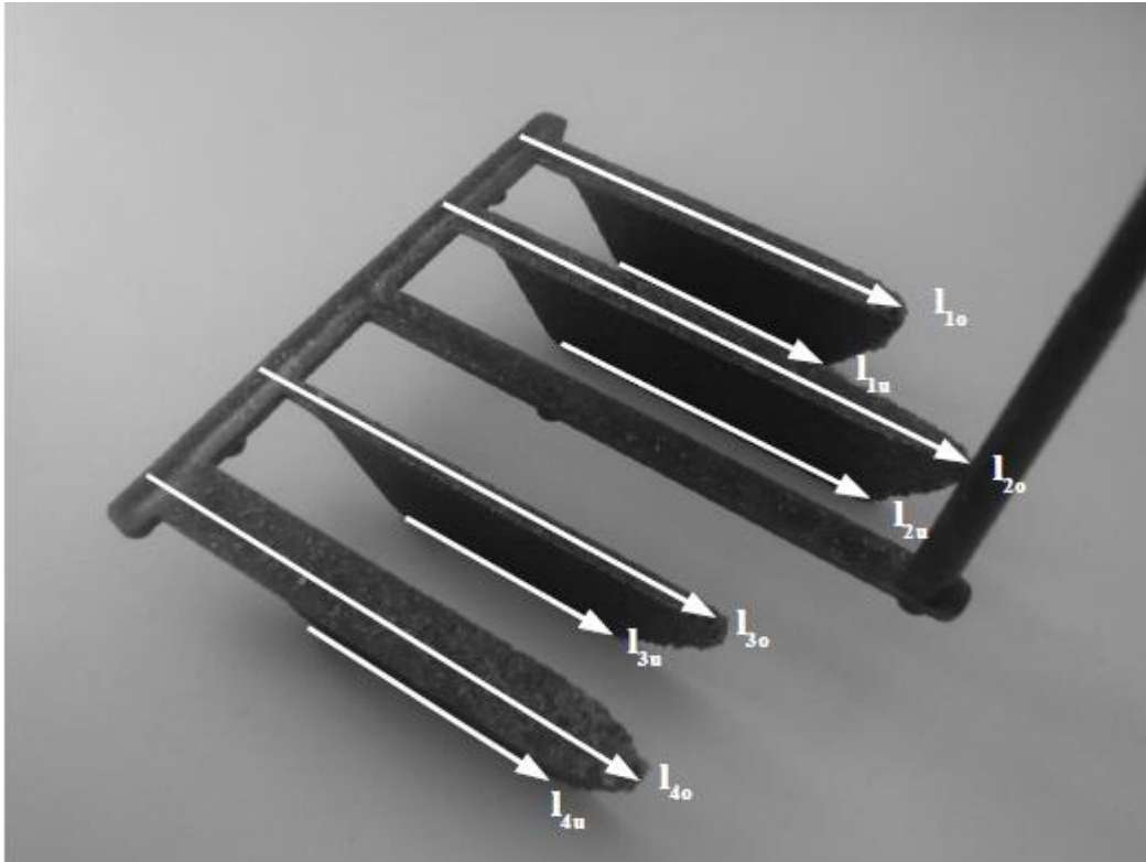
Figura 5.3.2 Lungimi ale nervurilor la simulare și la studiul de umplere
