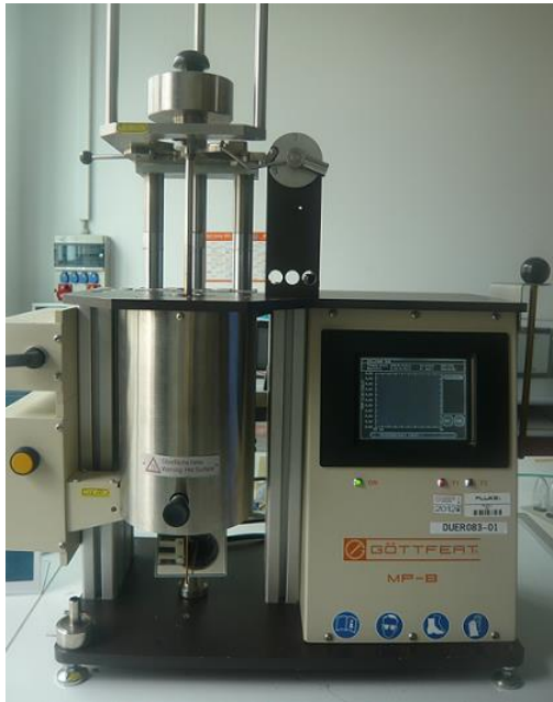
Figura 4.3.5 Aparat pentru determinarea indicelui de curgere a topiturii (st.) și schema bloc (dr.)
