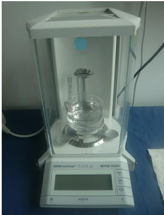
Figura 4.6.17 Cântarul pentru determinarea densității
