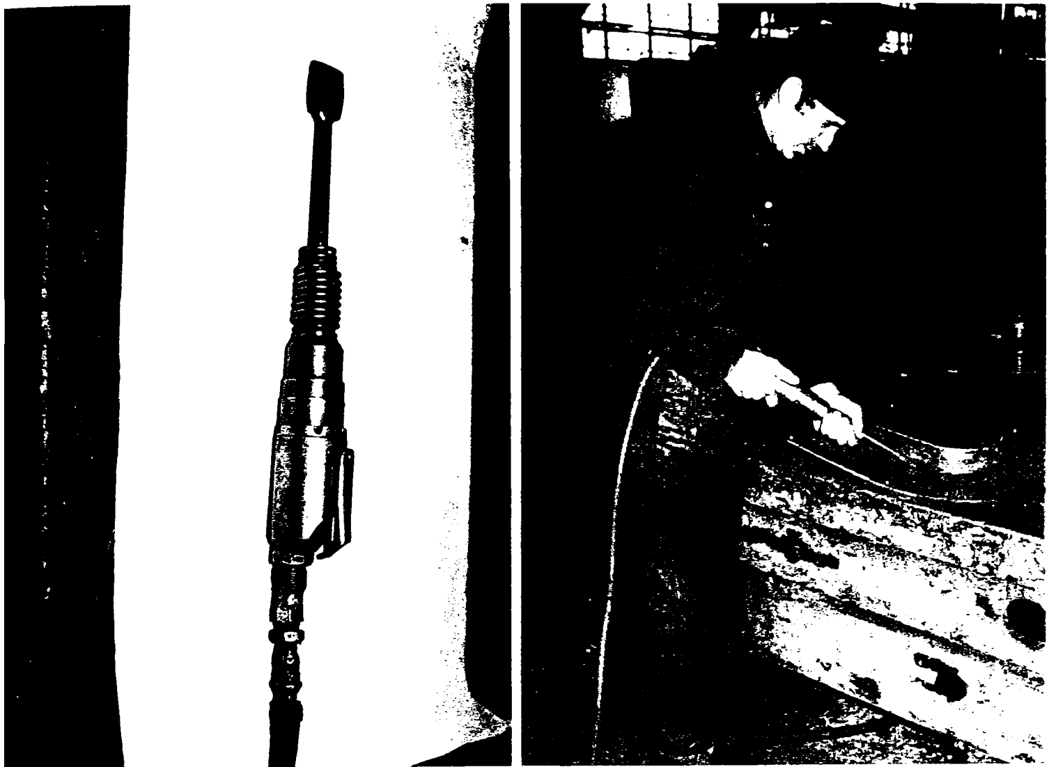
Fig. 4.11 Imaginea sculei de lovire (a) și a instalației de durificare a suprafeței prin deformare la rece (b).
