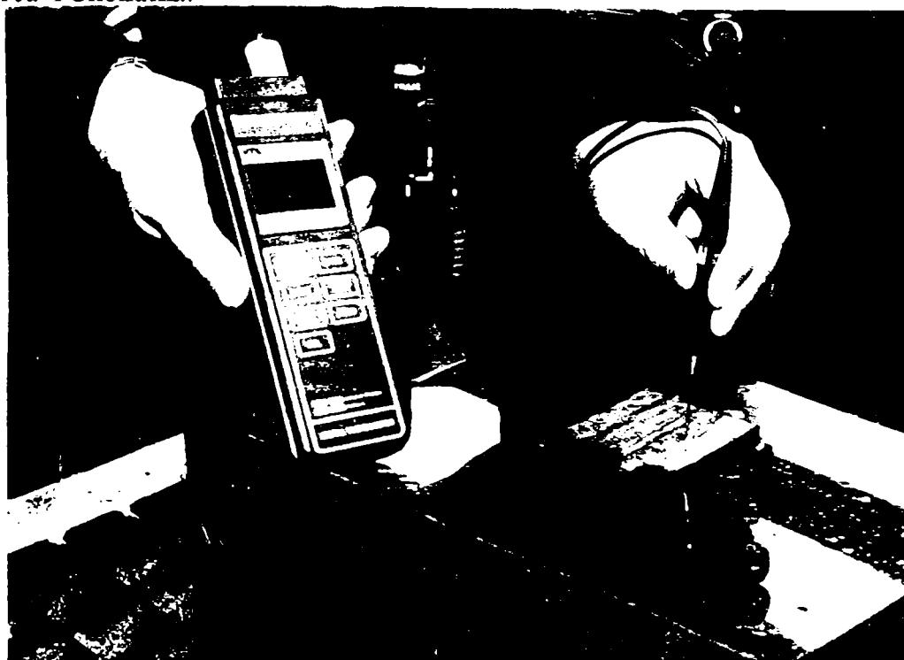
Fig. 2.4 Măsurarea temperaturii între treceri
