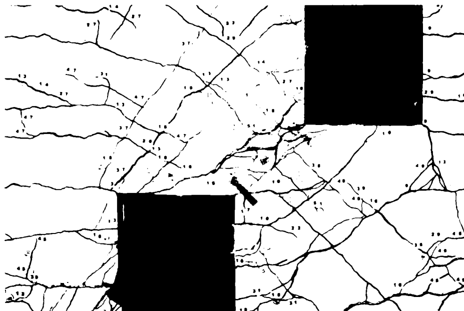
Figura 5. 6 Distribuția fisurilor între golurile de la parter și etaj în stadiul limită ultim
