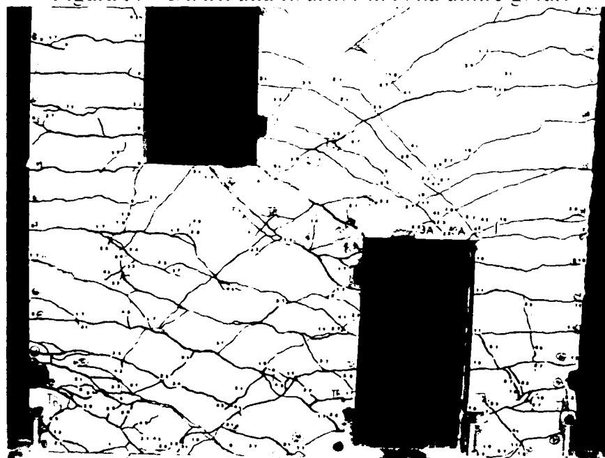
Figura 5. 10 Distribuția fisurilor la baza modelului experimental SW4-5
