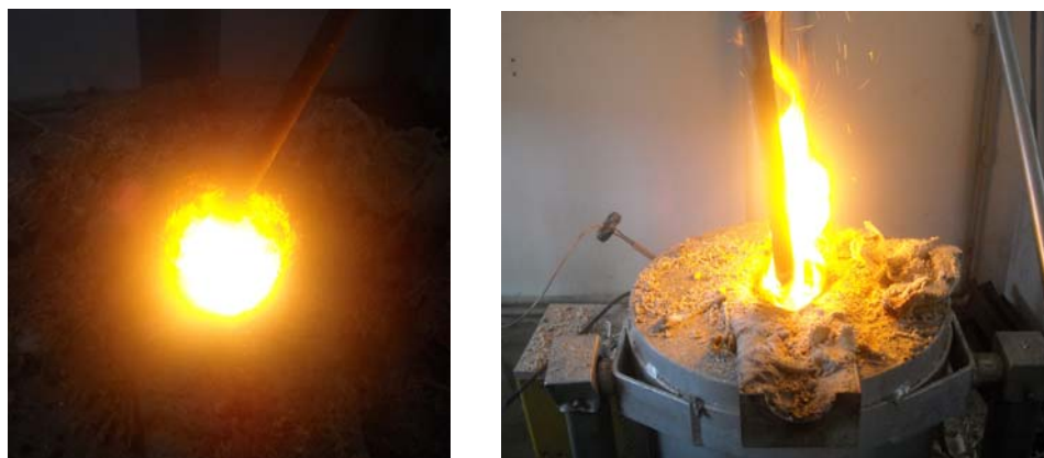
Fig. 4.2. Imersia amestecului reducător pentru formarea zgurii sintetice
