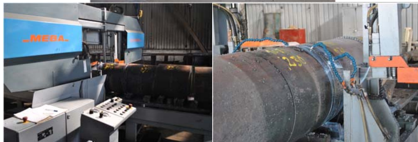
Fig.2.12. Crestarea lingourilor în calupuri destinați fabricației roților monobloc [19]
