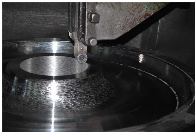
Fig.2.14. Prelucrarea roților monobloc pe strunguri CARUSEL cu comandă numerică
