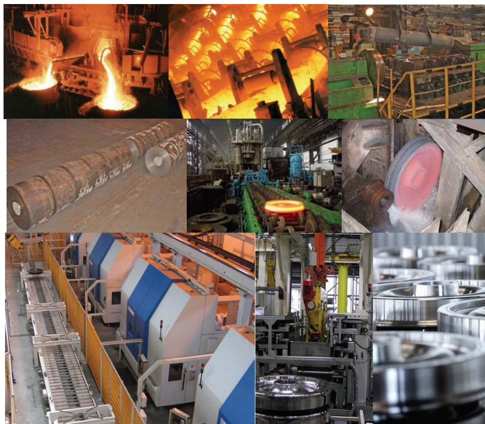
Fig.2.4. Producerea roților monobloc la JSC „Interpipe NTRP” Ucraina [7]
