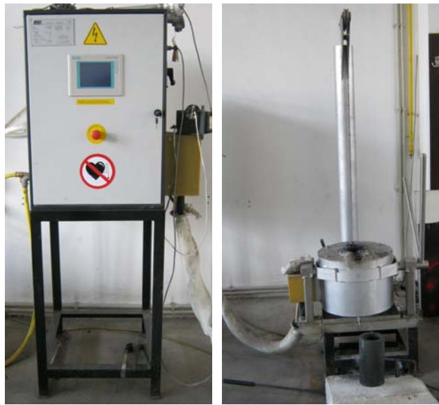
Fig.4.1. Cuptor cu inducție, capacitate 10kg
