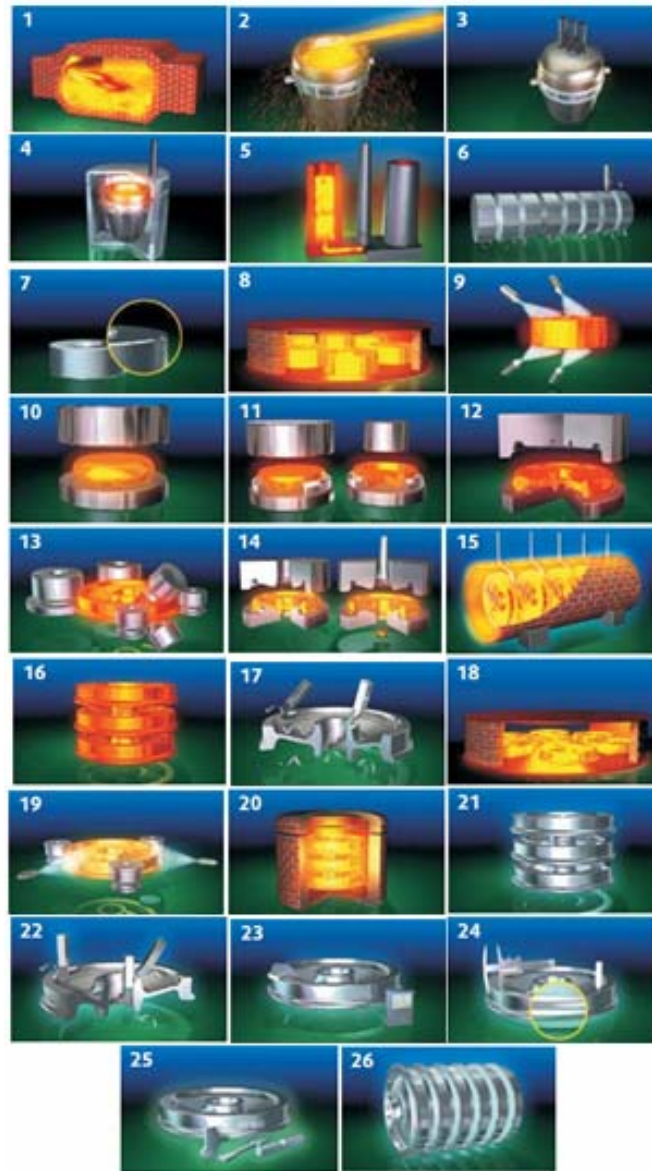
Fig. 2.6. Fluxul tehnologic de producere a roților monobloc de cale ferată [7]:
