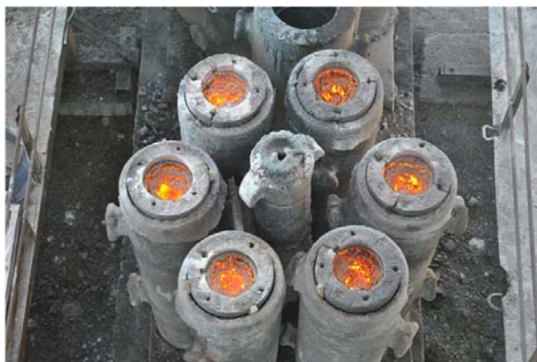
Fig.2.10. Turnarea oțelului în lingouri de formă cilindrică [19]
