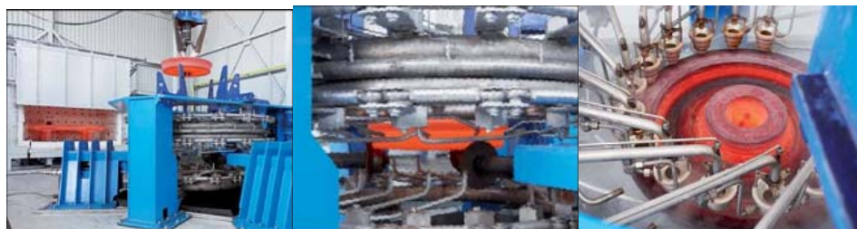
Fig.2.3. Aspecte din timpul procesării roților monobloc prin procedeul ACT
