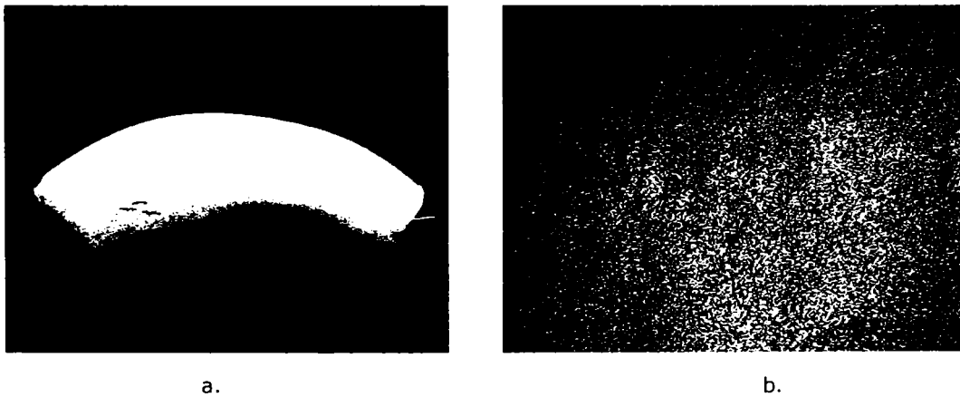
Figura A7.4. Extrudat de HDPE la temperatura de 190°C – Experiment de tip A, cu activare ultrasonică.
