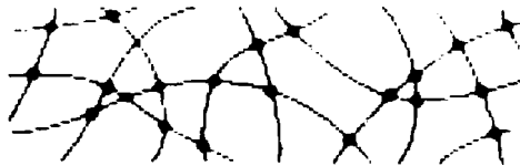
Figura 1.4. Structura schematizată a polimerilor termorigizi [OLI 07]
