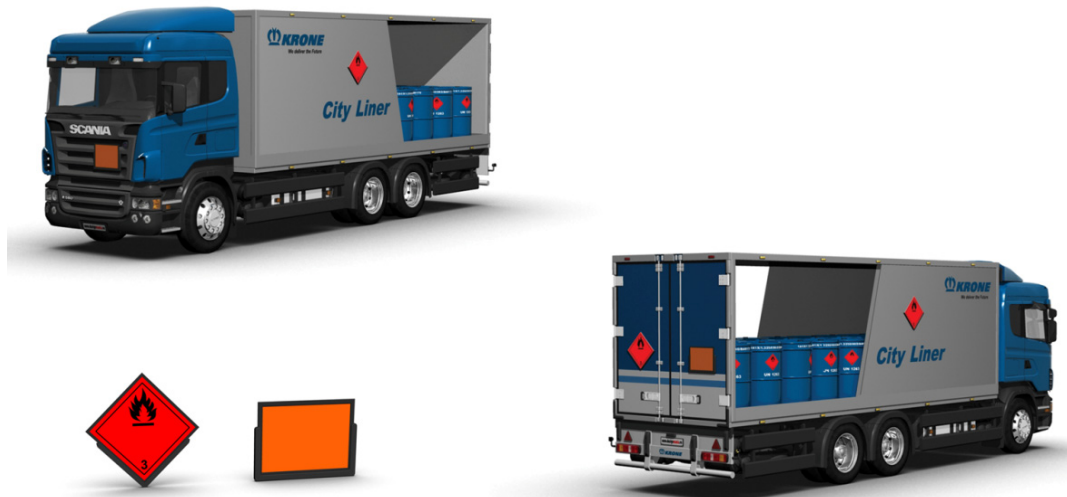
Fig. 6.1 Autovehicul care transportă amoniac ambalat în butoaie și semnalizarea corespunzătoare transportului
