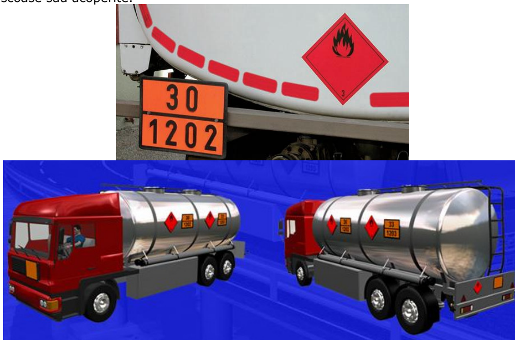
Fig. 2.9 Vehiculele cisternă semnalizate cu panouri cu numere laterale și panouri neutre în față și spate
