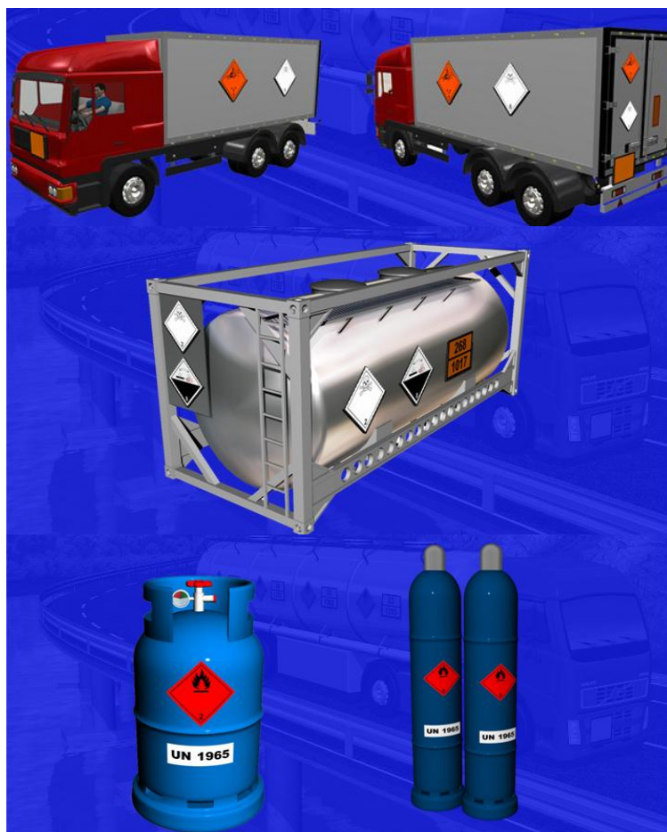
Fig. 2.10 Exemple de aplicare a etichetelor de pericol pe container cub, container cisternă, respectiv ambalaje
