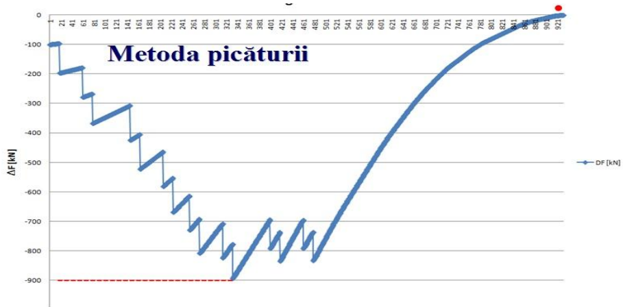
Figura 3.4.1. Metoda Picăturii („Rainflow“)
