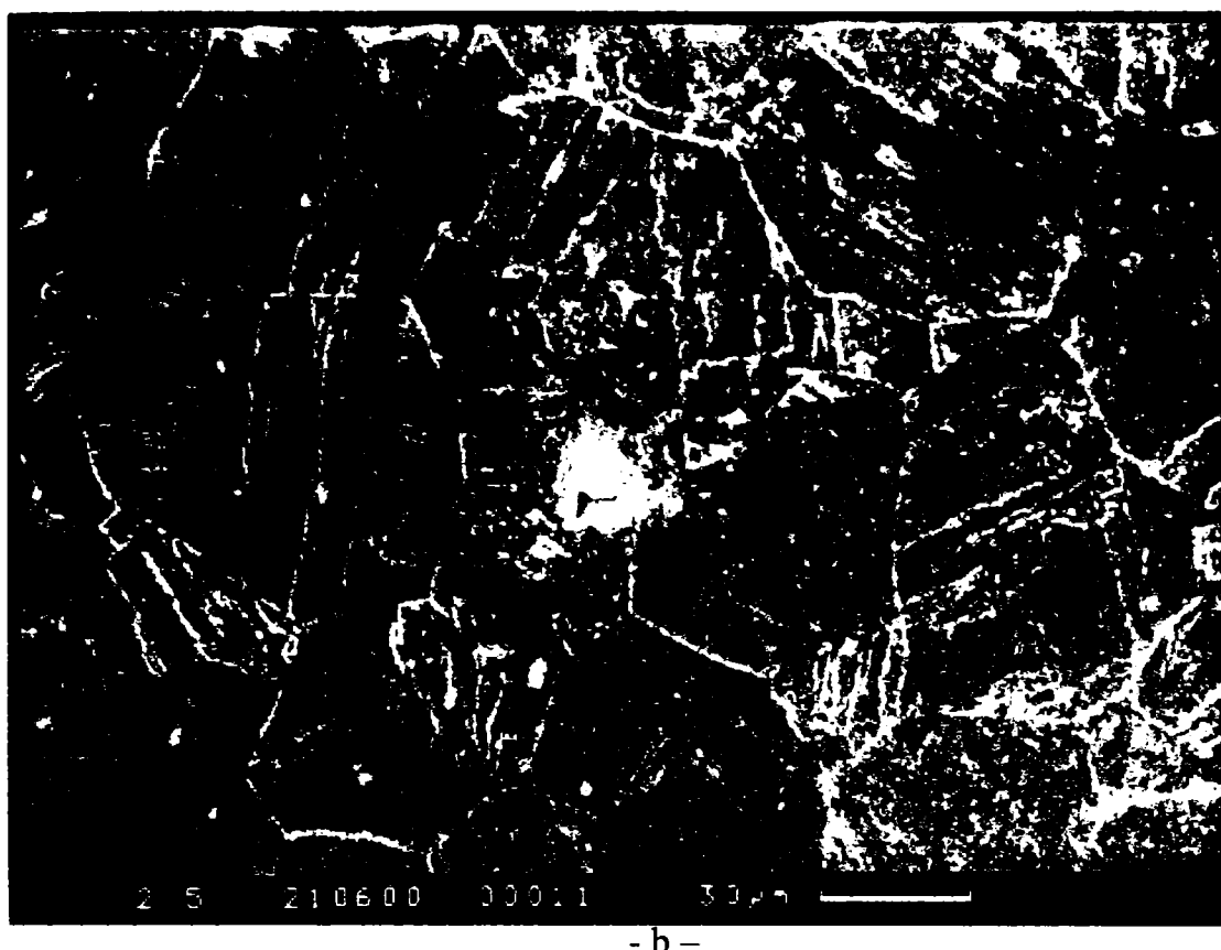
Fig. 5.2 Microstructura probelor testate la coroziune intercristalină
