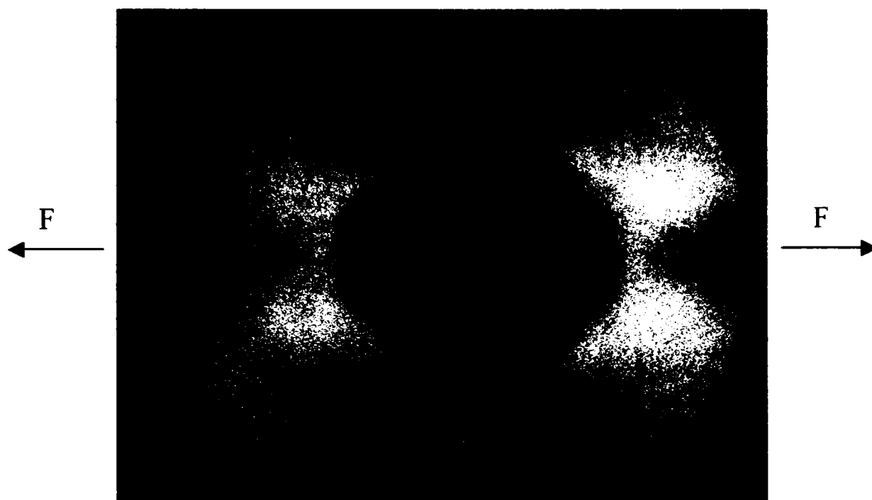
Fig. 5.6.9. Franja 2, la F=21 \times 15.35 \text{ N} = 322,350 \text{ N} (21 diviziuni)
