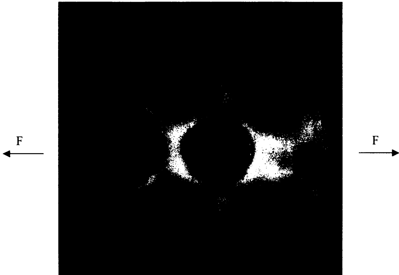
Fig. 5.6.49 , Franja 2, la F=46 \times 15.35\text{N}=706.1\text{N}
