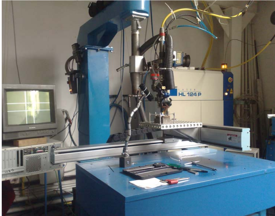
Figura 1. Aparatura necesară optimizării retopirilor cu laser a suprafețelor depuse prin pulverizare termică
