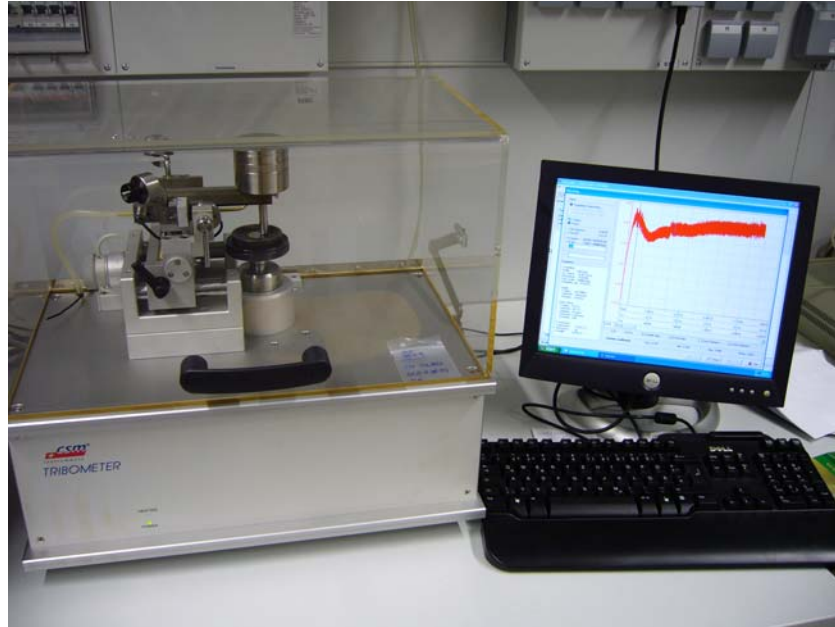
Figura 1. Tribometru de tip CSM pin-on-disc utilizat pentru determinarea coeficienților de frecare și a ratelor de uzare
