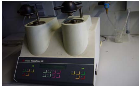
Figura 2. Mașină înglobare la cald Struers ProntoPress-20
