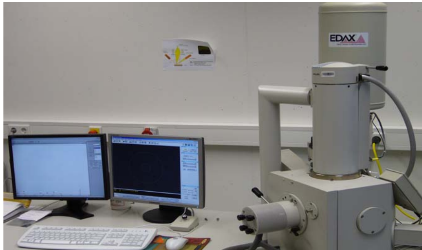
Figura 1. Microscop electronic cu baleiaj de tip ESEM XL 30-FEI Company
