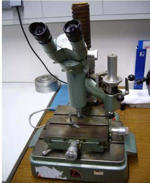
Figura 1. Microdurimetru de tip Zwick Z3.2A
