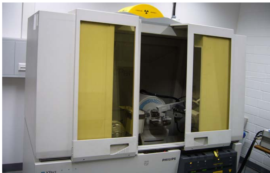
Figura 2. Difracțometru cu raze X de tip Philips X'Pert
