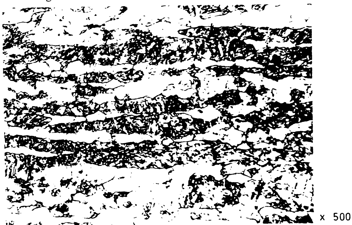
Fig.4.15 Microstructura de călire – deformare cu \psi = 35\%
