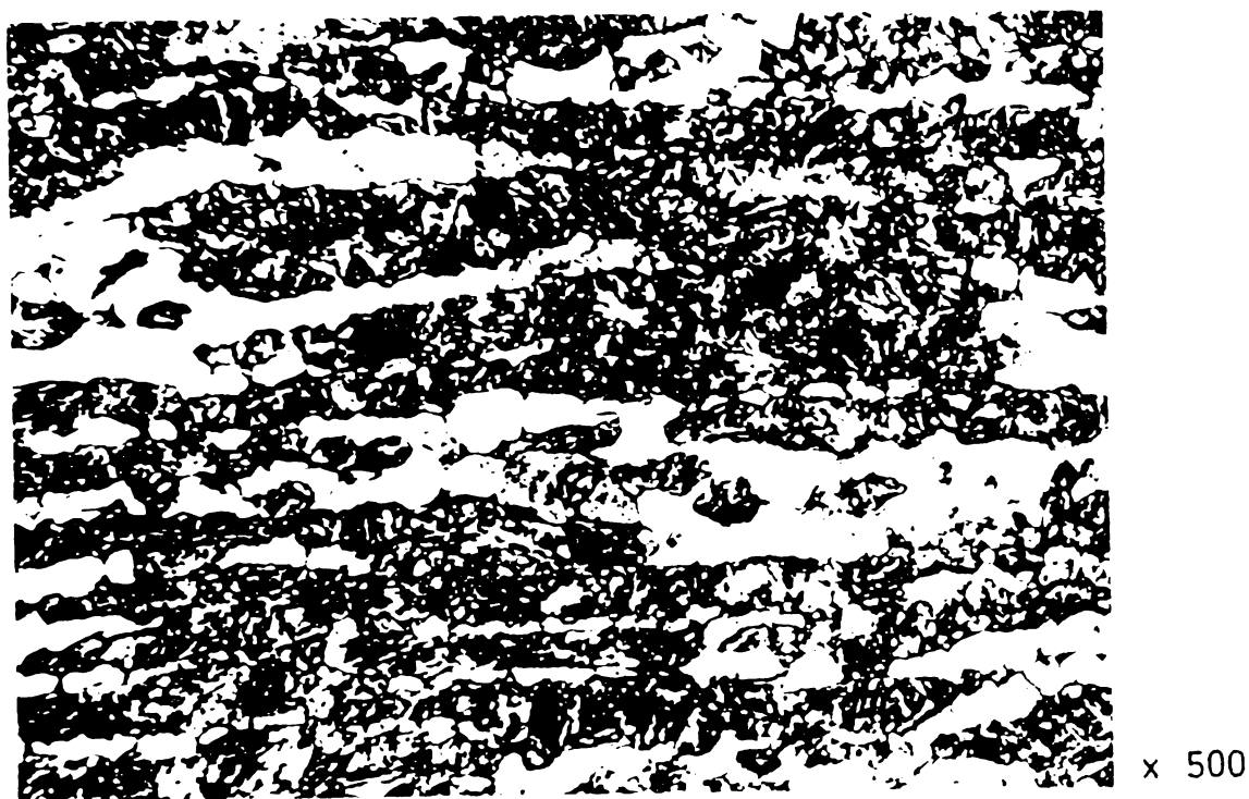
Fig.4.18 Microstructura de călire – deformare cu \psi = 35\% și revenire la 450^{\circ}\text{C}/2\text{h}/\text{aer}
