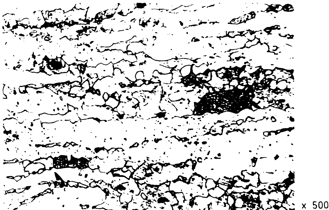
Fig.4.13 Microstructura oțelului analizat după călire pentru punere în soluție de la 1050°C
