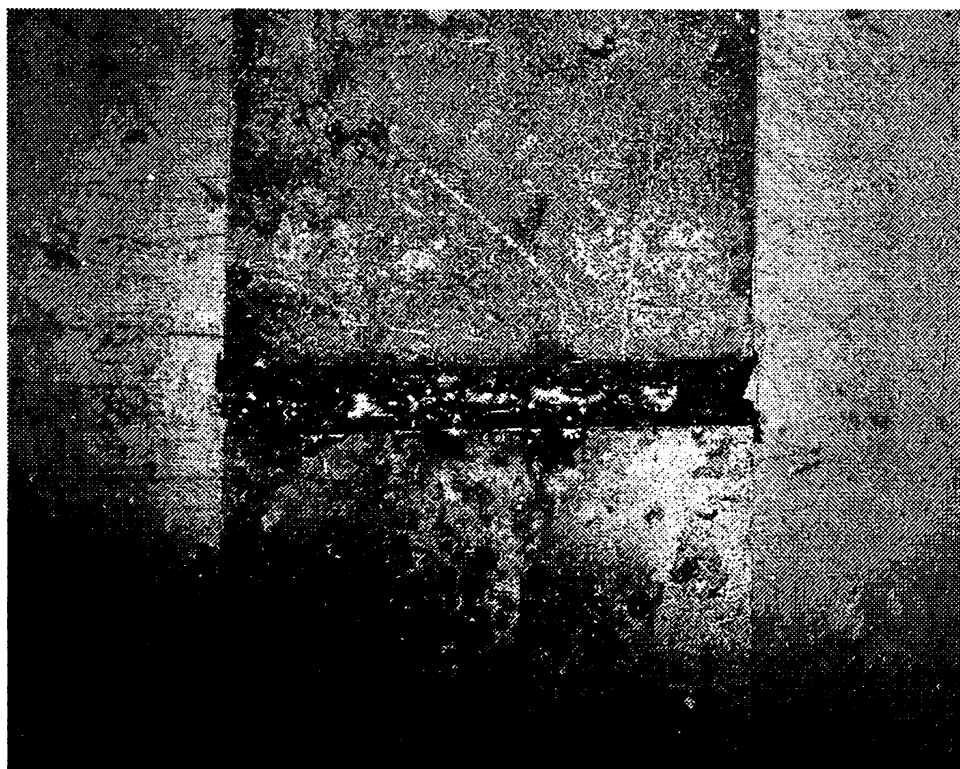
Fig. 4.12 Depunere discontinuă datorată vitezei mari de sudare (150 cm/min) combinată cu o frecvență mare de oscilare a capului de sudare (15 Hz)
