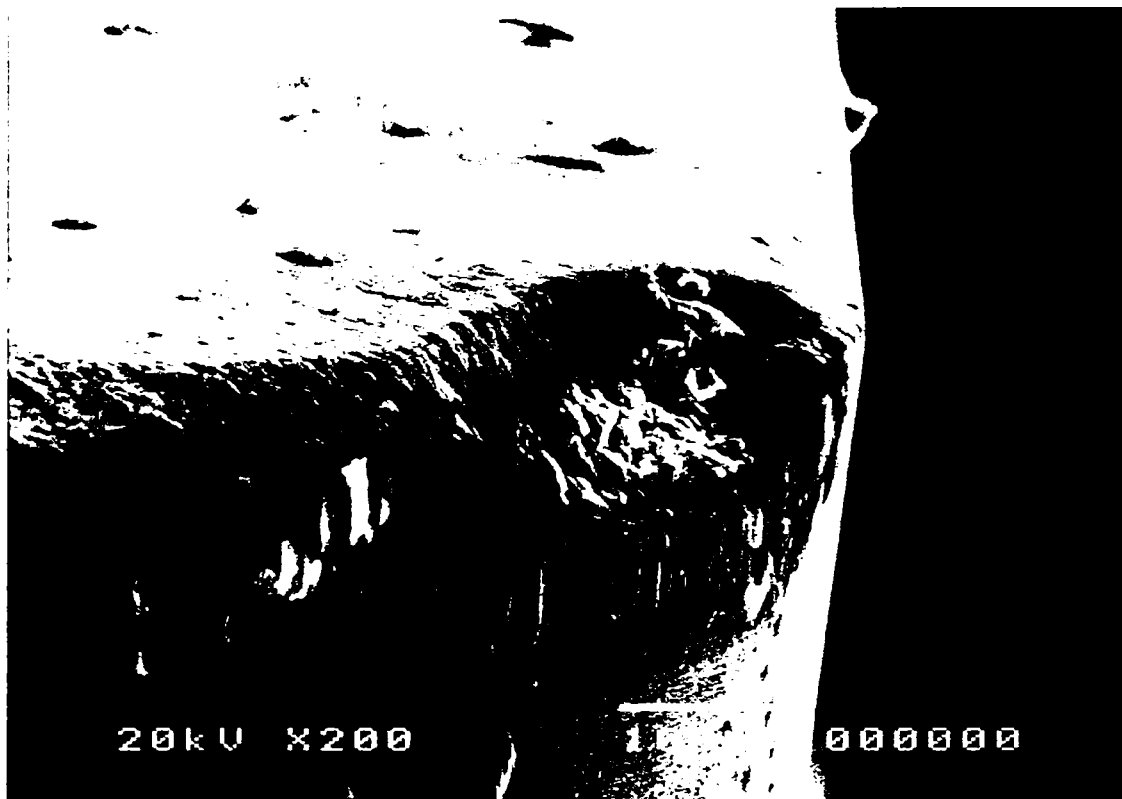
Figura 4.89. Uzura plăcuței din ceramică CC650 la așchiera oțelului 100Cr6 cu duritatea 60-62HRC cu următorul regim de așchiere: V_c = 180 m/min, f_n = 0,06 mm/rot, a_p = 0,25 mm, V_B = 0,2 mm, mărire X200, durabilitatea T = 38,76 min
