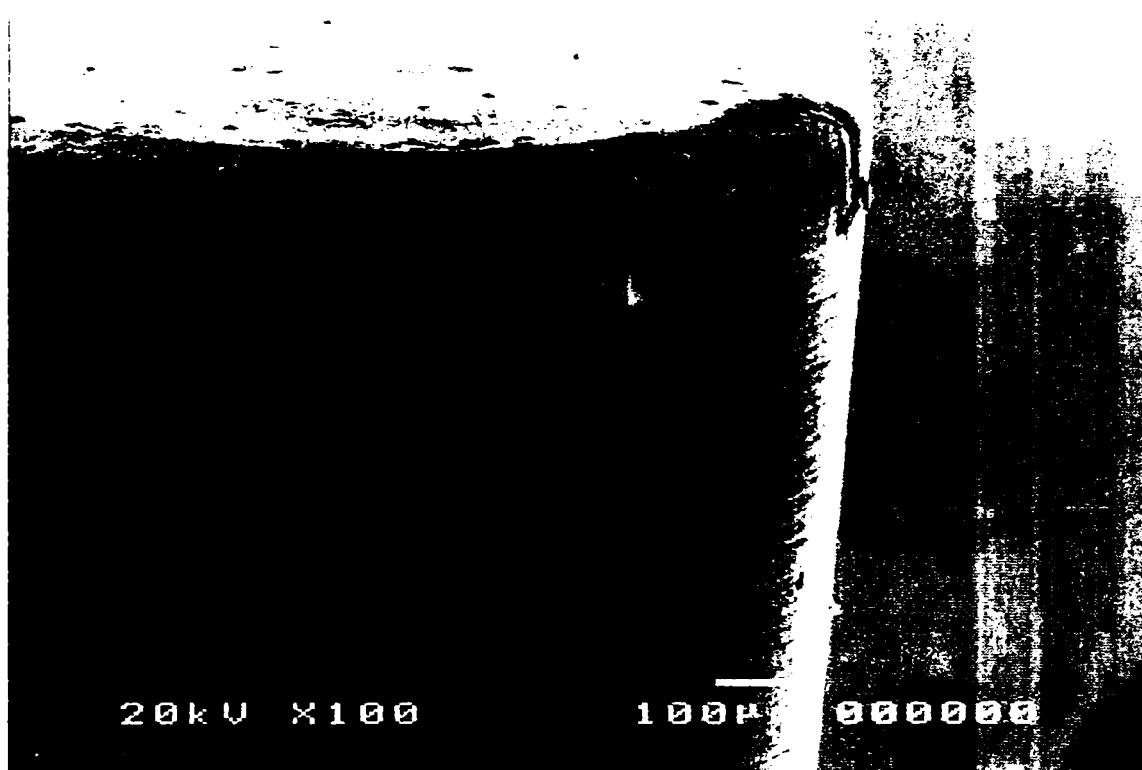
Figura 4.84. Uzura plăcuței din nitrură cubica de bor CB7020 la aşchiera oțelului 100Cr6 cu duritatea 60-62 HRC cu următorul regim de aşchiere: V_c=100 m/min, f_n=0,06 mm/rot, a_p=0,25 mm, V_B=0,2 mm, mărire x100, durabilitatea T=190 min
