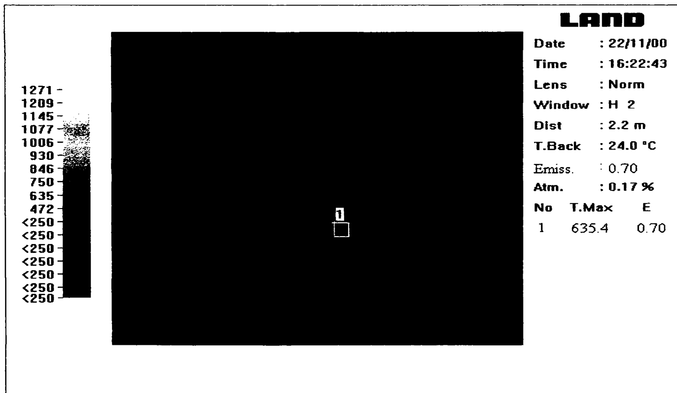
Figura 4.212. Temperatura înregistrată în cazul primei măsurători, în zona de contact sculă-semifabricat la așchierea oțelului 100Cr6 cu duritatea 60-62 HRC cu plăcuța DBN45 utilizând următorul regim de așchiere: V_c=140 m/min, f_n=0,14 mm/rot, a_p=0,25 mm
