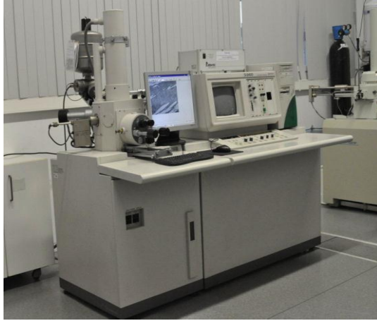
Figure 3.4: Hitachi S-2400 SEM
