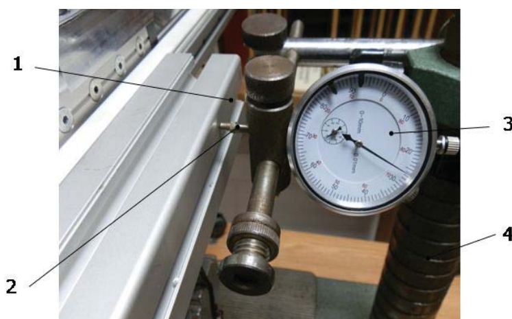
Figura 6.4 Stand experimental pentru determinarea experimentală a erorii de repetabilitate a axei Y
