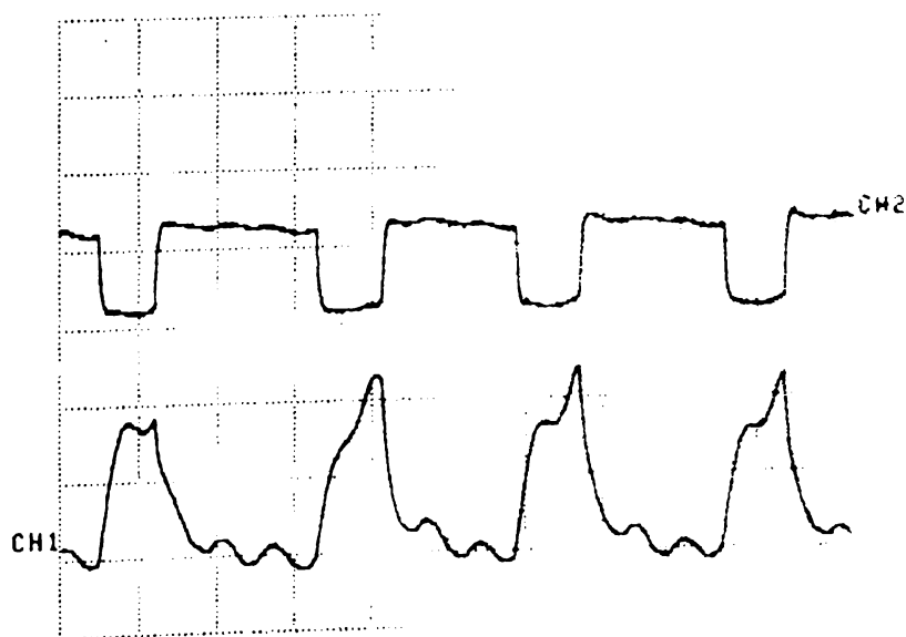
Figura 5.8. Oscilograma parametrilor tehnologici I_s , U_a la f_p = 80 Hz
