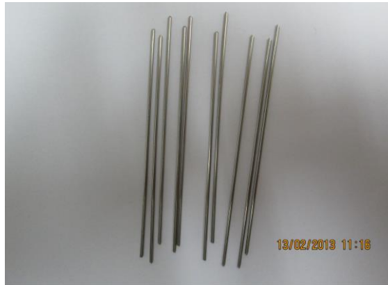
Fig. 4.24. Imaginea unui set de epruvete pentru încercări la oboseală multiaxială
