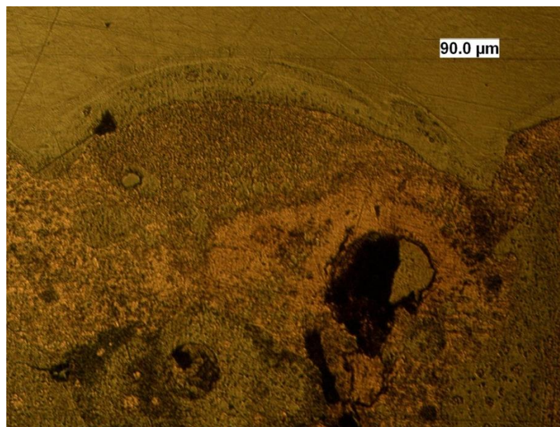
Fig.3.31 Microstructura interfeței sudură-oțel inoxidabil: 1500 W/14 ms/0,32 m/min.; 152 μm (proba 15)
