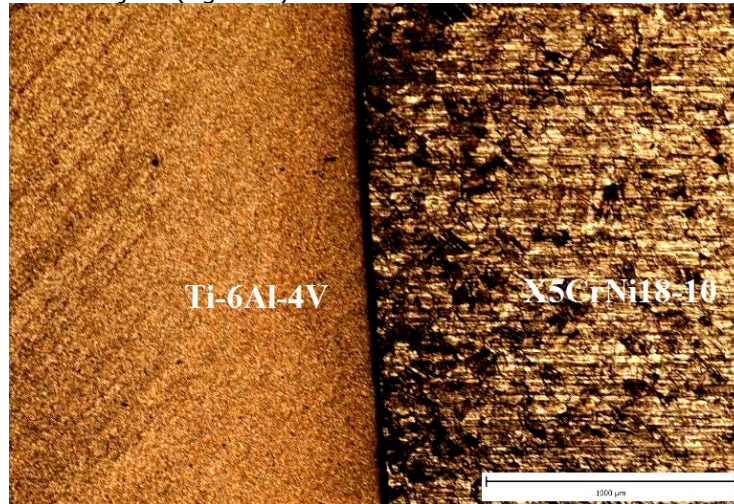
Fig.4.16 Microstructura îmbinării sudate realizate la o presiune mai mare de refulare
