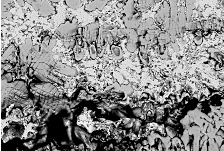
Fig. 3.33 Microscopie electronică cu baleiaj: zona de combinații chimice pe interfața sudură - aliaj de Ti
