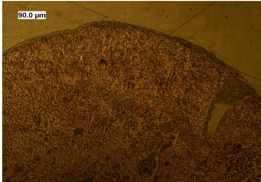
Fig.3.28 Microstructura interfeței sudură-oțel inoxidabil: 1400 W/14 ms/0,32 m/min.; 58 μm (proba 4)
