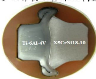
Fig. 4.15 Macrostructura unei secțiuni prin îmbinarea sudată
