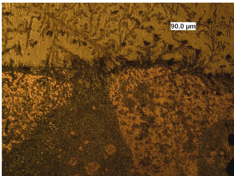
Fig. 3.25 Microstructura sudurii în vecinătatea interfeței cu oțelul inoxidabil:1400W/14ms/0,25m/min.;82 μm (proba 2)
