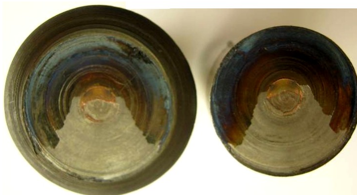
Fig. 4.18 Imaginea macrografică a suprafețelor aflate în contact pentru t_r=8 s și presiune axială 20/20 N/mm 2
