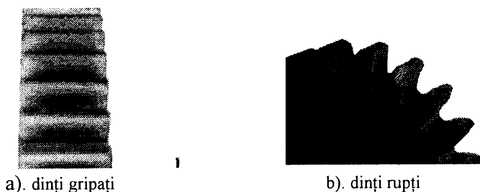
Fig.4.4. Roți cu defecte
