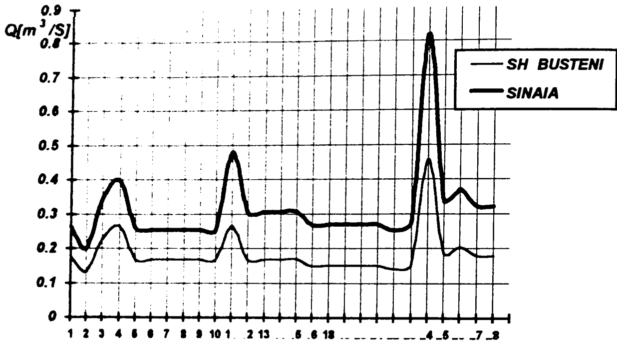
Fig. 8.6. Variația debitului râului Prahova în secțiunile Bușteni și Sinaia - Luna FEBRUARIE 1993.
