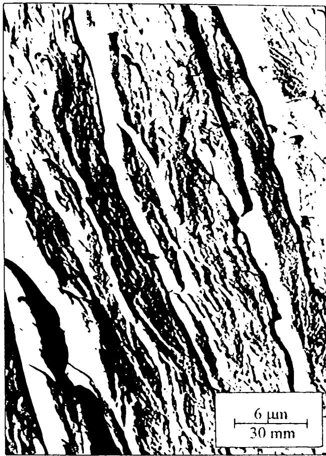
Fig.4.107 Piesă strunjită ( R_a = 3.2 \mu\text{m} )
