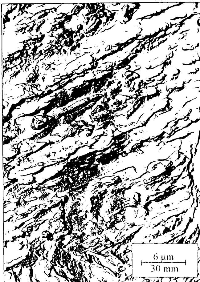
Fig.4.109 Piesă lepuită ultrasonic ( R_a = 0,16 \mu\text{m} )
