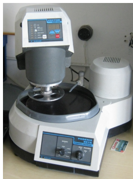
Fig. 3.67 Aparatul de șlefuit și lustruit Buehler Phoenix Beta
