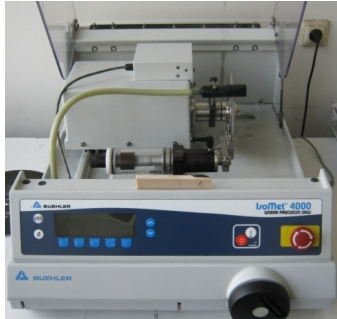
Fig. 3.65 Aparatul de tăiat cu pânză BUEHLER 4000
