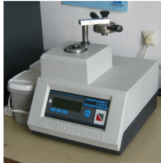
Fig. 3.66 Aparatul de înglobat la cald BUEHLER SIMPLIMET 1000
