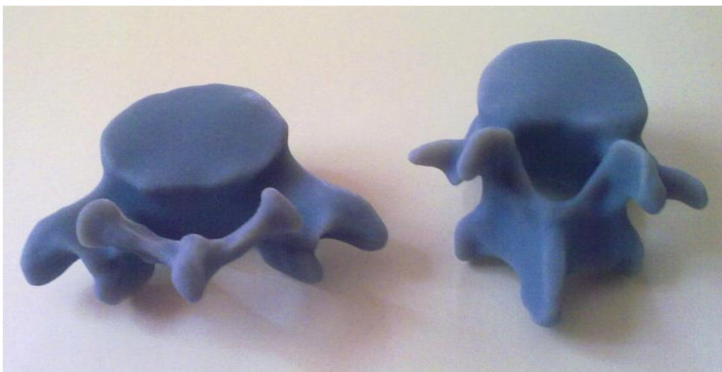
Fig. 6.13 – Vertebrele L4 și L5 rezultate în urma prototipării: a.) vertebrele extrase din imprimanta 3D; b.) forma finală a vertebrelor.
