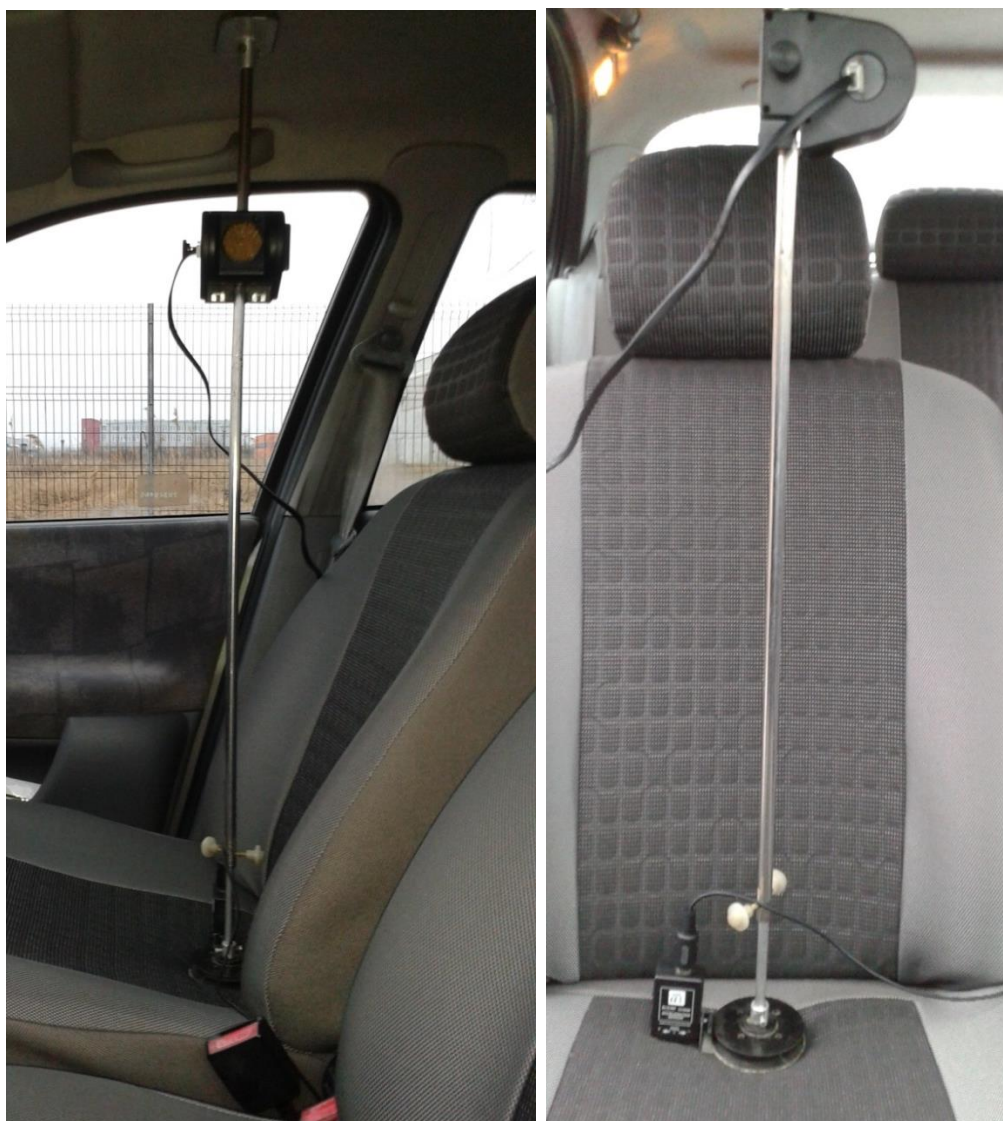
Fig. 3.21 Suportul vertical și fixarea senzorului pe acesta.
