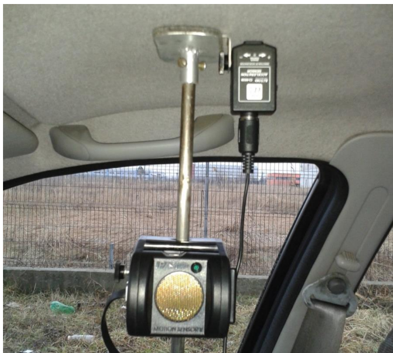
Fig. 5.9 Poziționarea accelerometrului pentru înregistrarea accelerațiilor în plan longitudinal.
