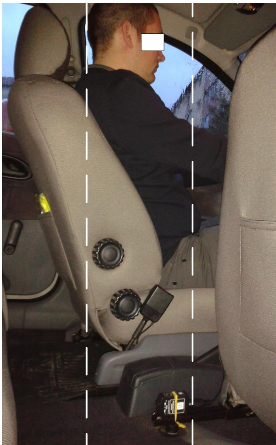
Fig. 4.9 Poziționarea accelerometrului față de capul conducătorului auto în plan vertical.
