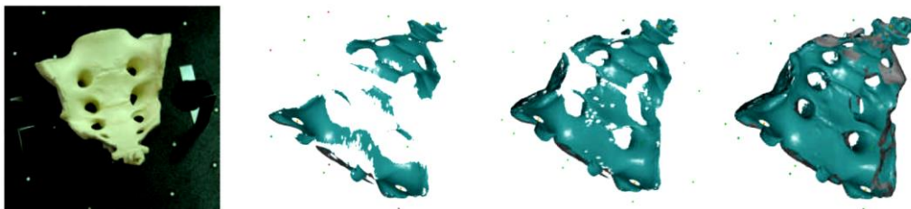
Fig. 3.34 Scanarea vertebrelor și achiziția norului de puncte. [17]
