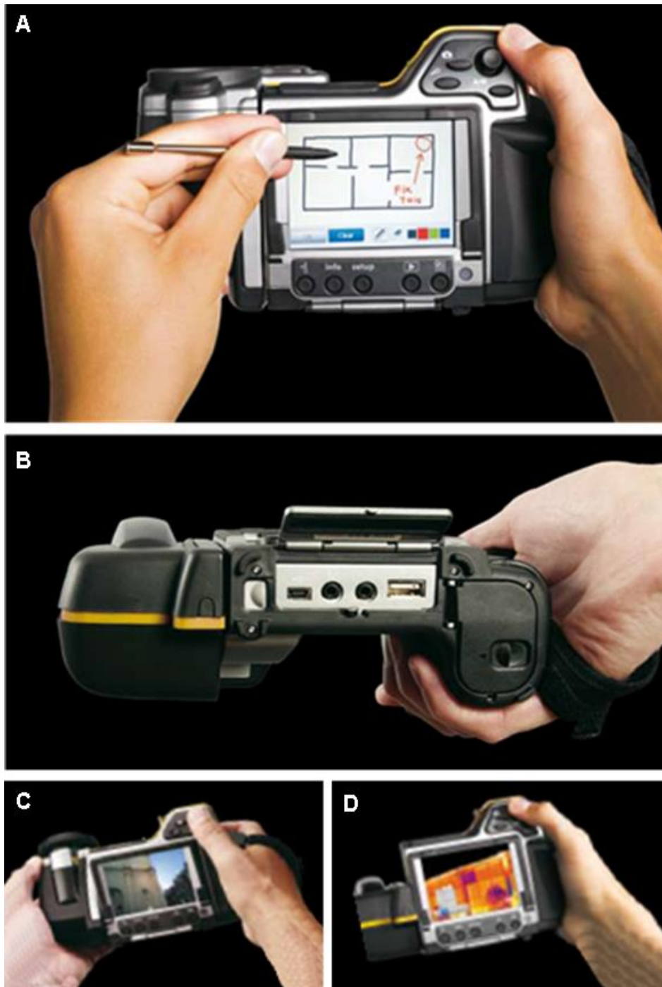
Fig. 5.34 Aparatul FLIR B200 utilizat în studiului termografic. A – fața posterioară a aparatului cu display-ul și setarea acestuia. B – fața inferioară a aparatului cu haburile de conectare. C – imagine fotografică normală la nivelul display-ului. D – imagine termografică a aceluiași obiect din figura C. [61]
