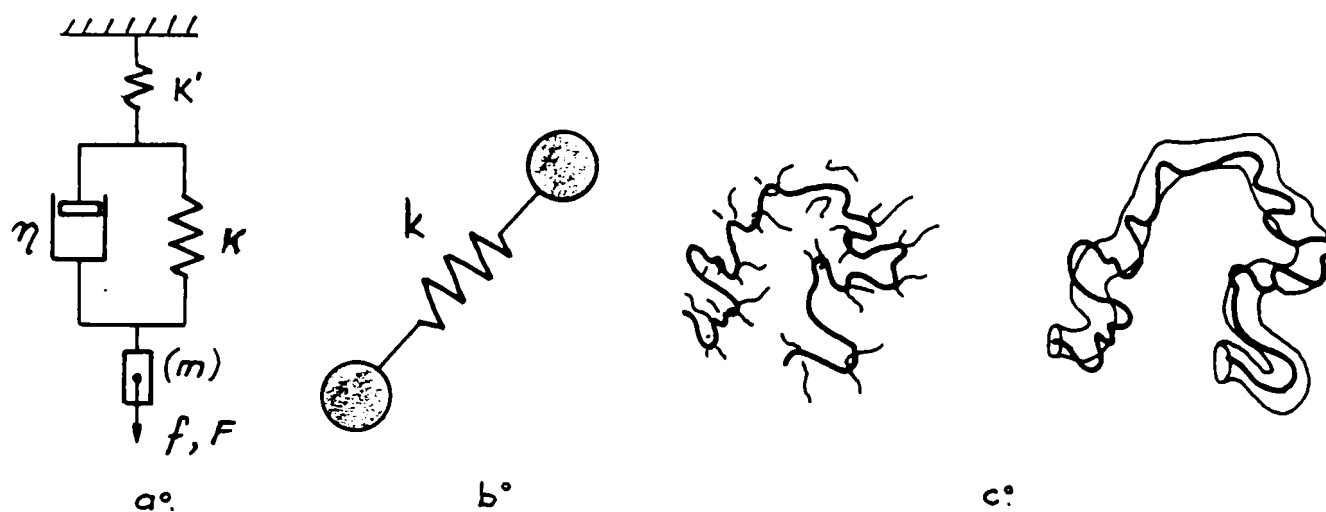
Figura 1.20 Model mecanic elastic echivalent pentru comportarea topiturilor de polimeri (Kuttruff, [70] Agassant, [3] Benallal [19] )
