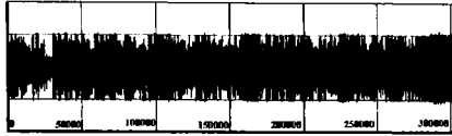
Fig. 3.2.111. Semnalul t_1 în al 11-lea ciclu de decorelare, în cazul algoritmului cu sistem de gradienti parțiali, fără utilizarea filtrelor Q_1 și Q_2 , cu parametrii mărime de pas \mu_1 și \mu_2 egali cu 0,0001.
