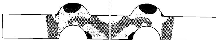
Figura 1.2.24 Repartiția densității de curent în cazul bosajului inelar
