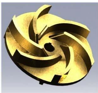
Fig. 1. 4 Rotor pompă centrifugă ( deschis), n_s=40-300
