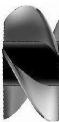
Fig. 3. 10 Impulsorul 3D, obținut în urma proiectării cu metoda inversă
