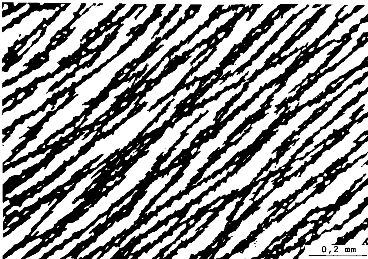
Fig.5.4. Aspectul structural al SMR-2 sub acțiunea câmpului magnetic longitudinal.
