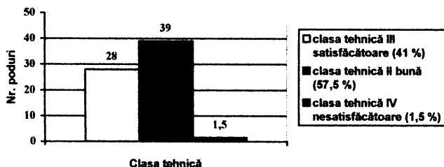
Fig. III.13. Starea tehnică a podurilor de pe DN6.
