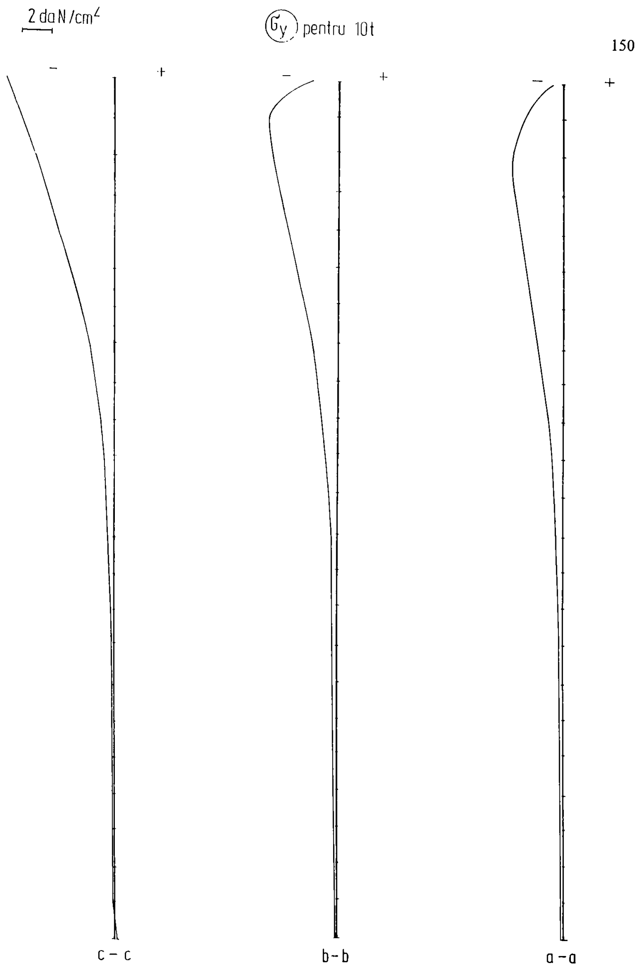
Figura 5. 21 EFORTUL \sigma_y ÎN ÎMBINARE - varianta 2
