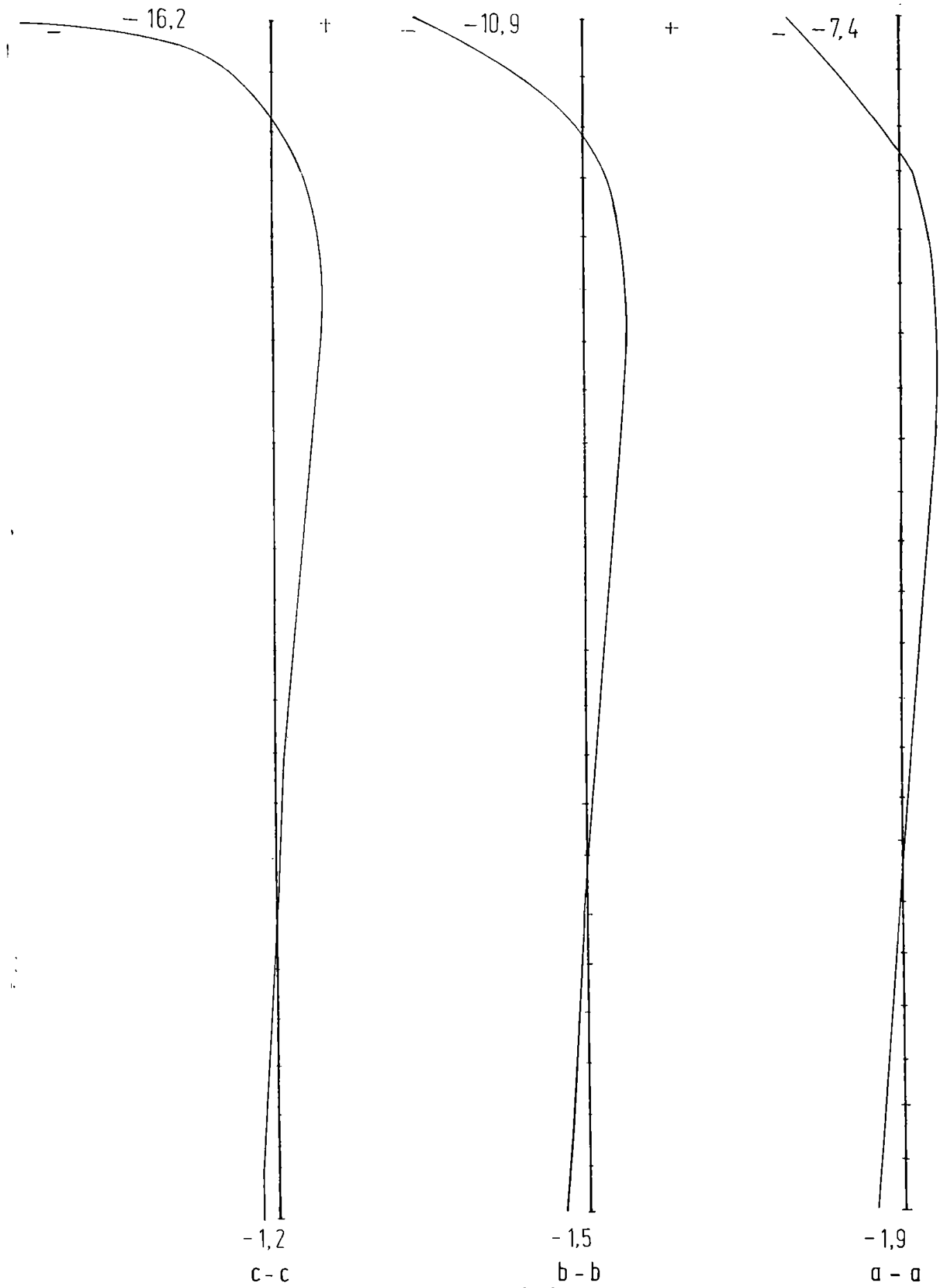
Figura 5. 20 EFORTUL \sigma_x ÎN ÎMBINARE - varianta 2
