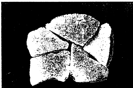
Figura 21. Aspectul unui gel monolit de izopropoxid de aluminiu modificat cu acid acetic
