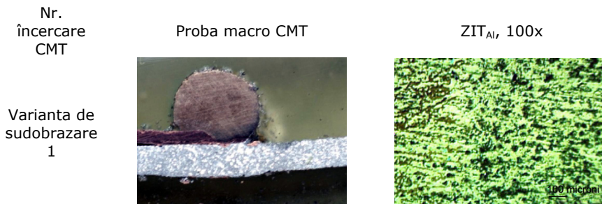
Figura 6.4 Analizele macro și microstructurale determinate la îmbinarea Cu-Al
