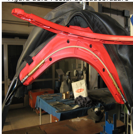
Figura a1.2 Dispozitiv tampon pentru variațiile vitezei de avans al sârmei
