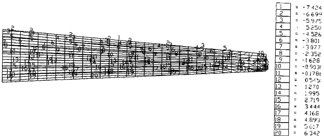
fig. 7.5.3 Repartitia tensiunilor compuse in domeniul studiat (tensiuni in N/mm^2 )
