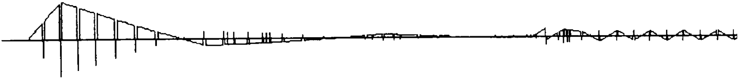
Figura 3 - Diagrama de momente încovoietoare - modelare linie axială MAN & BW 5S60MC (Greutate proprie + Excitații + Reazeme modelate ca bare cu rolă la capăt)
