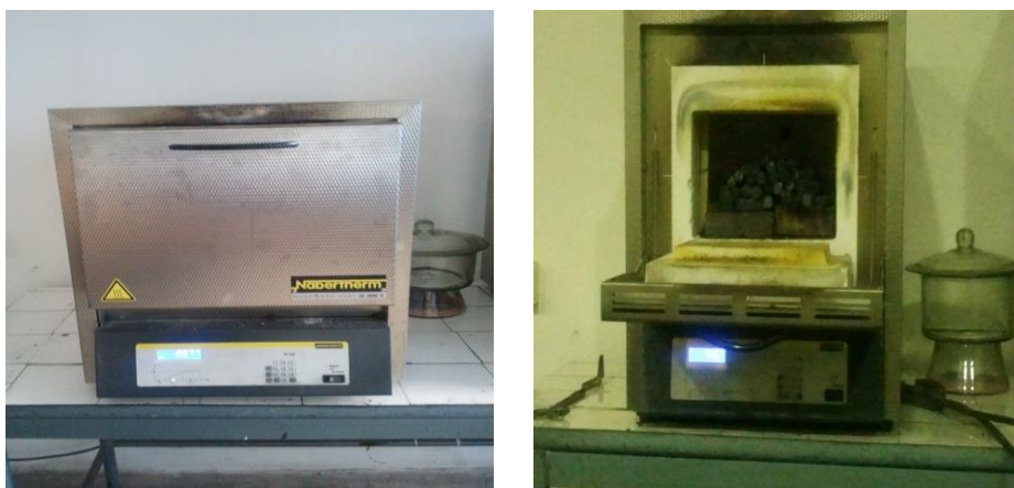
Fig.5.19. Cuptor electric cu vatră fixă pentru efectuare tratamentului termic
