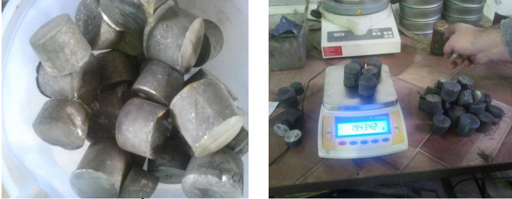
Fig.5.2. Încăcătura metalică compusă din oțel și fontă
