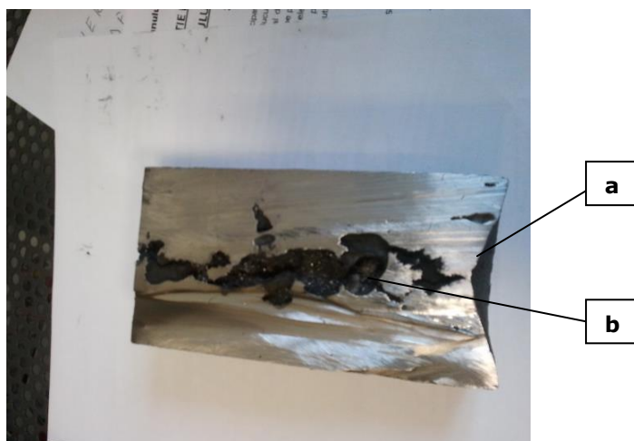
Fig.5.17. Retasuri: a – principală; b – secundară
