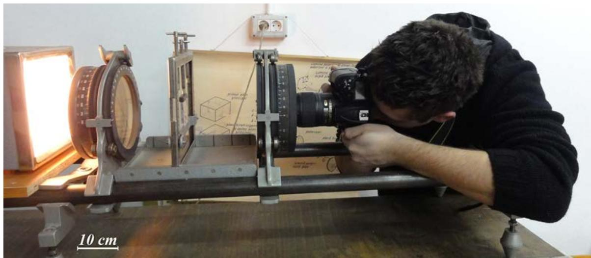
Figure A2.6 Le système d'analyse photoélastique.
