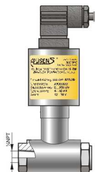
Aplisens APRE-2000PD -5-70mbar; precizie \pm 0,10\% ; semnal pe 2 fire; presiune statică max.250bar
