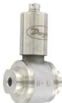
Dwyer 655A-04-C 0-15inw.c.=0-37,363mbar; precizie \pm 0,25\% ; semnal pe 4 fire; presiune statică max.68,95bar
