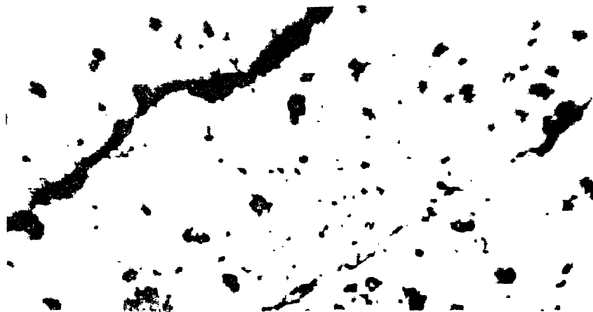
Figura 3.26. - Micrografia inițierii și propagării fisurilor în materialele piezoceramice, (prelucrată și scanată de PC; 500x)
