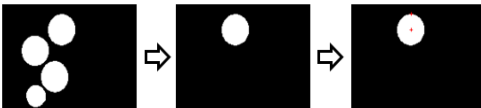
Figura 7. 13: Extragerea rulmentului cu y minim și determinarea punctelor P1 și P3
