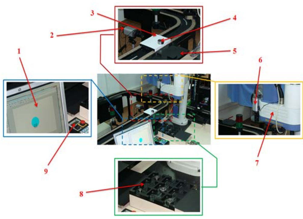
Figura 7. 1: Standul experimental 1) calculatorul pe care rulează aplicația; 2) camera CCD 2; 3) căruciorul conveierului; 4) piesa - rulmentul; 5) buffer; 6) camera CCD 1; 7) robotul SCORA-ER14; 8) depozitul de piese; 9) teach pendant.
