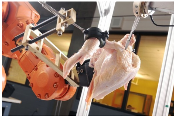
Figura 2. 22: Operația de tăiere și dezosare a unei găini (GTRI 2012).
