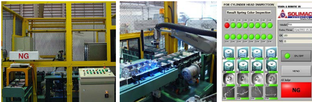
Figura 2. 16: Sistemului de inspectare SOLIMAC (SOLIMAC, 2012).
