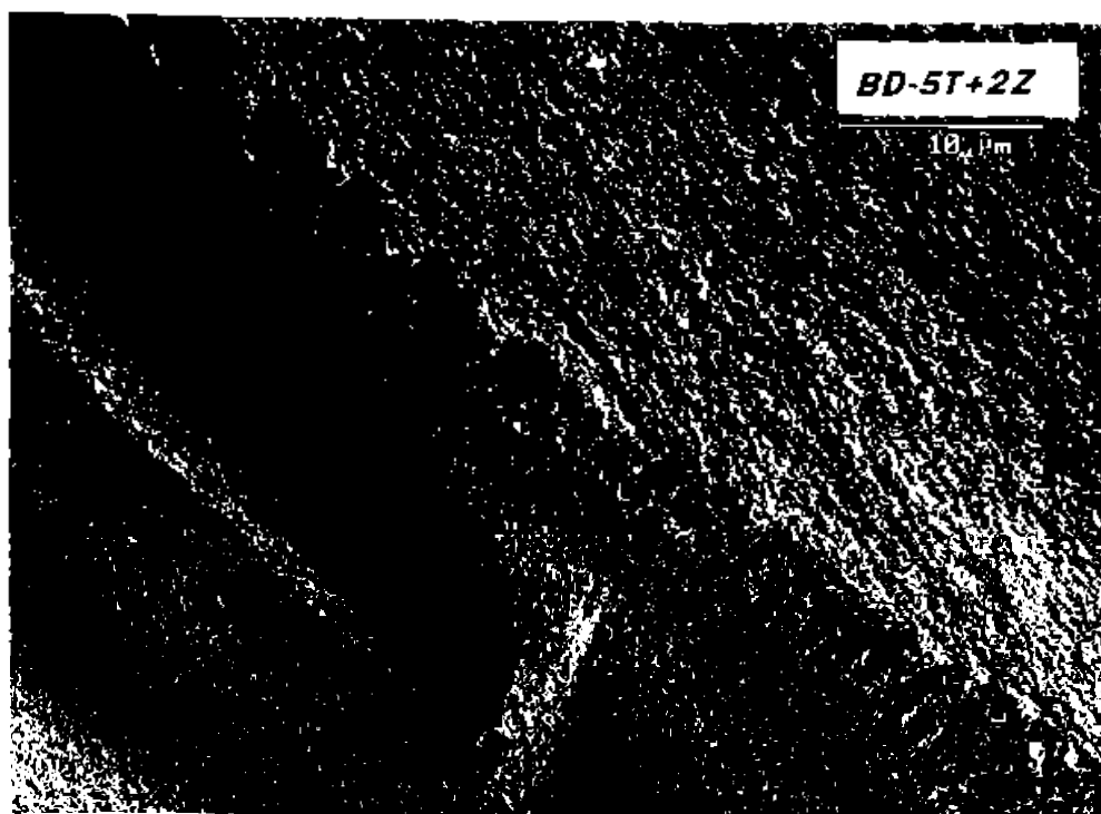
Figura 4.3. Imaginea electronmicroscopică a suprafeței de rupere prin impact a vitroceramicii experimentale BD-5T+2Z.
