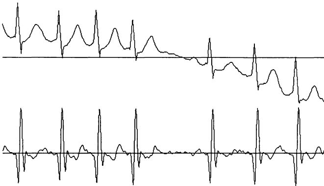
fig. 3.27. Șablonul S5 aplicat unui semnal cu derivă lentă a liniei de bază.
