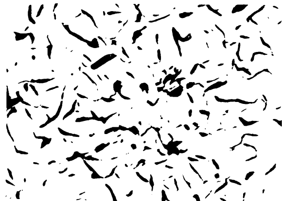
Fig. 6.5. Structura metalografică a fontei cenușii de a doua fuziune Fc 200 , obținută în cuptorul electric cu inducție , microaliată cu cupru ( 0,70...0,90 % ) și crom ( max. 0,15 % ) , prin retopirea fontei sintetice și corectarea compoziției chimice : a. 500 : 1 ; b. 100 : 1 .
