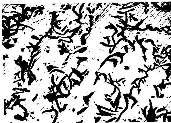
Fig. 6.2.A spectul grafitului din fonta cenușie de a doua fuziune Fc 250 , obținută în cuptorul electric cu inducție prin retopirea fontei sintetice și corectarea compoziției chimice :100 : 1 .
