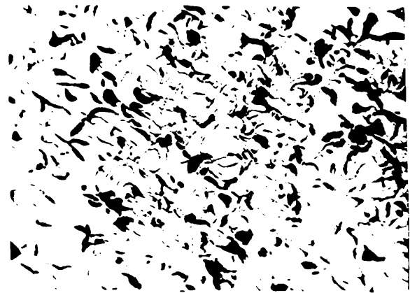
Fig. 5.3. Structurile metalografice ale fontelor brute de furnal barbotate cu argon în oala de turnare și retopite în cuptorul electric cu inducție ( 100 : 1 ) : a. fără adaos ; b. cu adaos de FeSi ; c. Cu adaos de SiCa ; d. cu adaos de Al .
