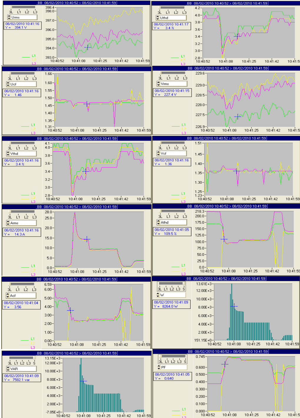
Fig. 2.12. Variația parametrilor electrici măsurați ( T_e = 1s ), P = 15kW , raport de transformare 3:1.
