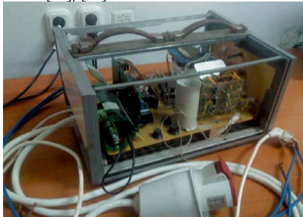
Fig. 2.15. Blocul de adaptare a curentilor și tensiunilor la sistemul de achiziție de date.
