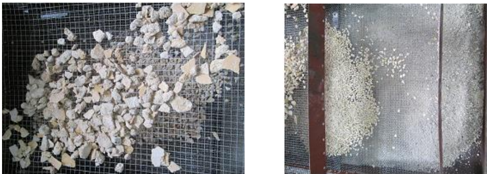
Fig.5.2. Tipuri de site calibrate utilizate la sortarea șlamului
