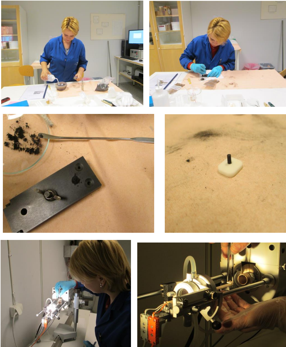
Fig.6.7. Etapele de pregătire a probelor pentru analiza cu Heating Microscop
