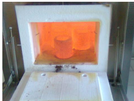
Fig.5.6. Durificarea peletelor în cuptor
