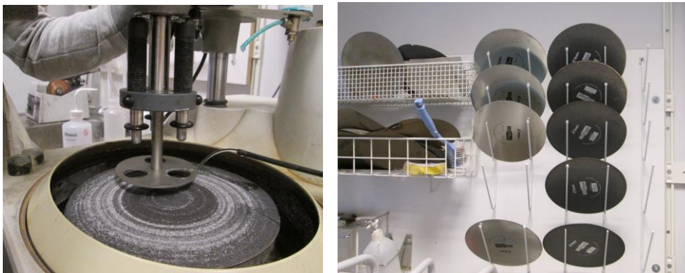
Fig.6.2.A Șlefuirea probelor cu diferite discuri
