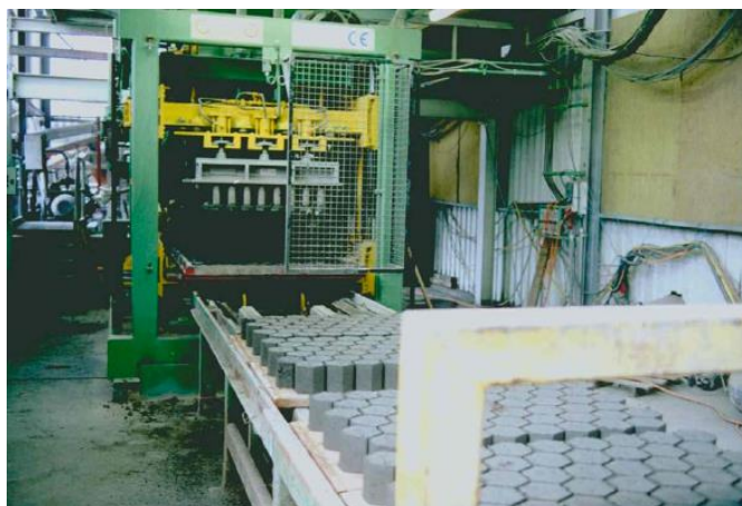
Fig.3.8. Brichete obținute prin presare și vibrație
