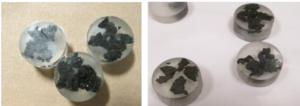
a, Fig.6.3. A Probe neșlefuite (a) și probe șlefuite (b)
