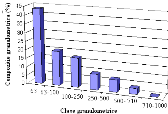
Fig.4.4. Compoziția medie granulometrică șlamului (N2) de la epurare (Galați)
