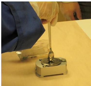
Fig.6.5.A Fixarea probei (e) în dispozitivul (f)
