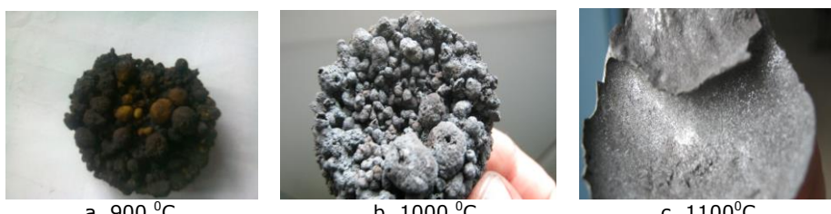
Fig.5.8. Probele după tratamentul de durificare la diferite temperaturi
