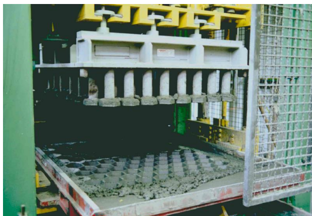
Fig.3.7. Compactarea materialelor prin presare și vibrație
