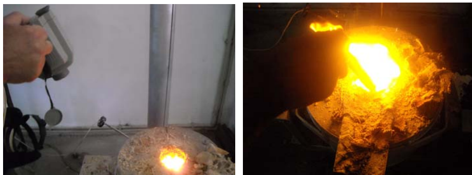
Fig.4.2. Măsurarea temperaturii băii metalice
