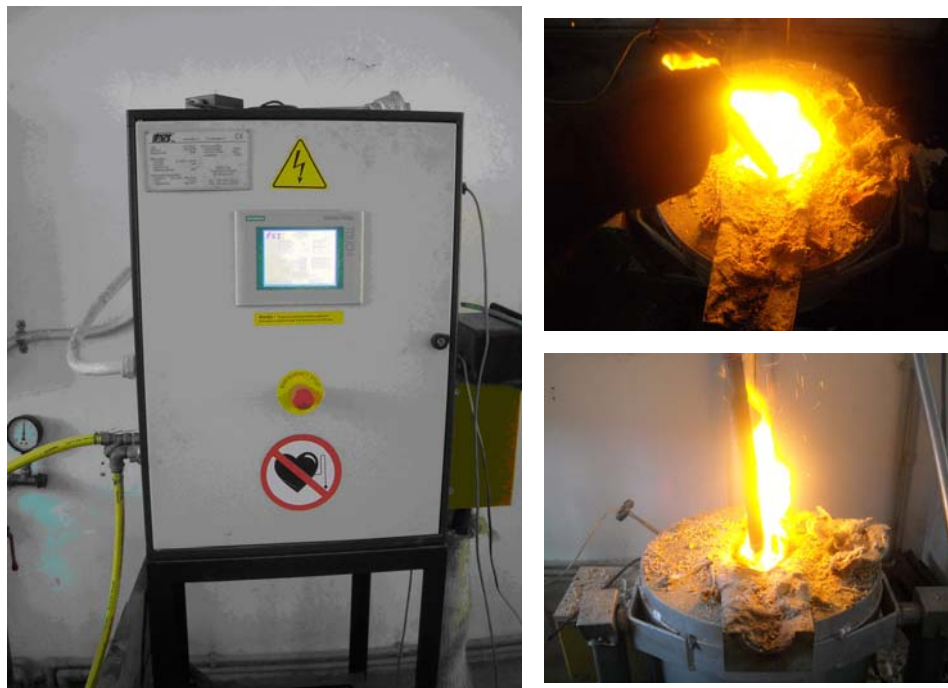
Fig.4.1. Cuptor cu inducție, capacitate 10 kg
