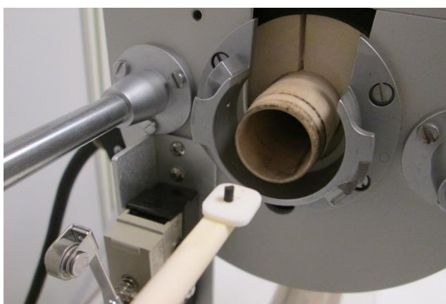
Fig. 6.7. A. Introducerea brichetei în microscopul cu încălzire
