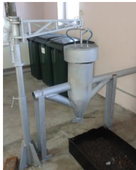
Fig. 4.9. Instalație de aglomerare
