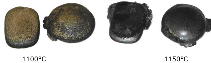
Fig. 3.58. Glazura P23 arsă timp de 30 minute la temperatura de 1100°C respectiv 1150°C.
