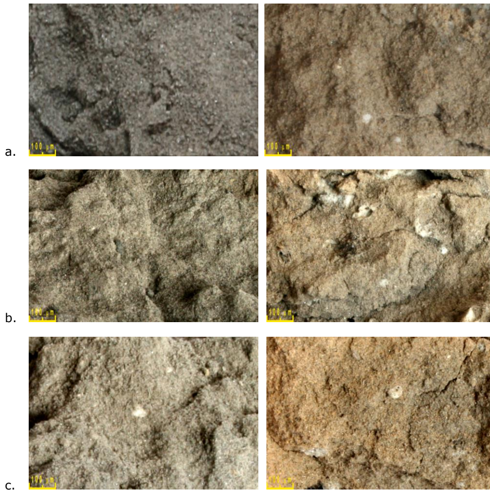
Fig. 3.89. Imagini microscopice (mărire 50x) ale sticlelor celulare obținute la 900°C, timp de 5 și respectiv 10 minute pentru probele:
