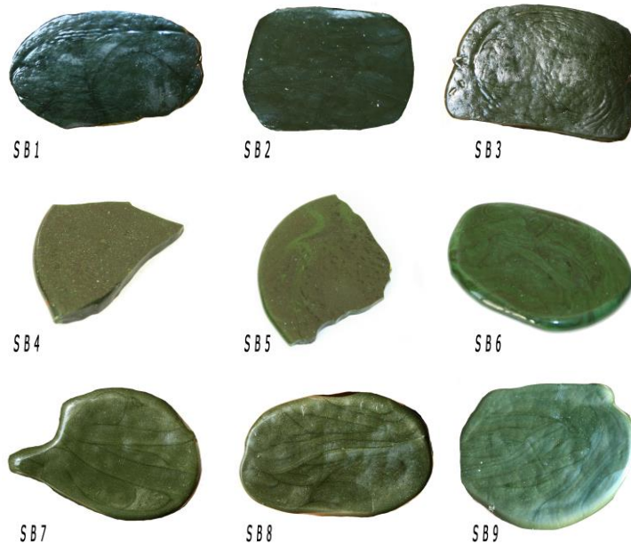
Fig. 3.35. Sticlele obținute din deșeuri de sticlă, cenușă și borax.
