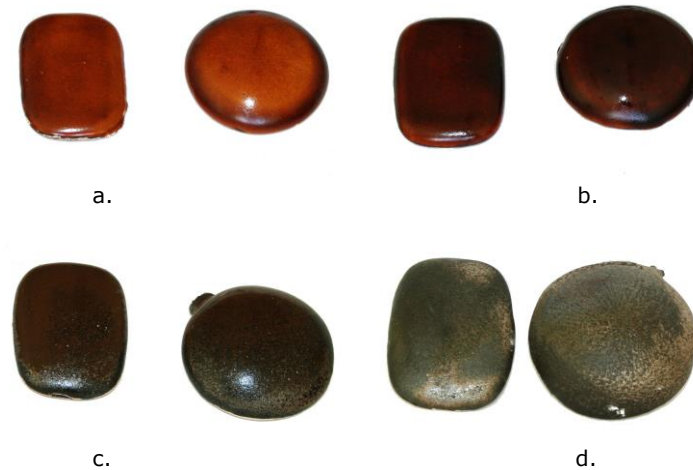
Fig. 3.61. Glazurile P28(a.), P29 (b.), 30 (c.) și P31 (d.), arse timp de 30 minute la temperatura de 1100°C.
