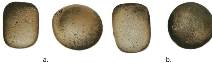
Fig. 3.60. Glazurile P26 (a.) și P27 (b.) arse timp de 30 minute la temperatura de 1100°C.
