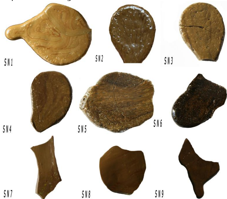
Fig. 3.19. Sticlele obținute din deșeuri de sticlă, cenușă și carbonat de sodiu.
