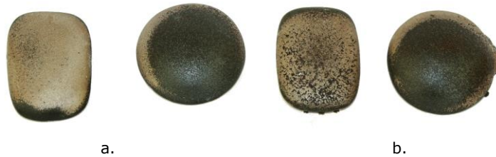
Fig. 3.59. Glazurile P24 (a.) și P25 (b.) arse timp de 30 minute la temperatura de 1100°C.
