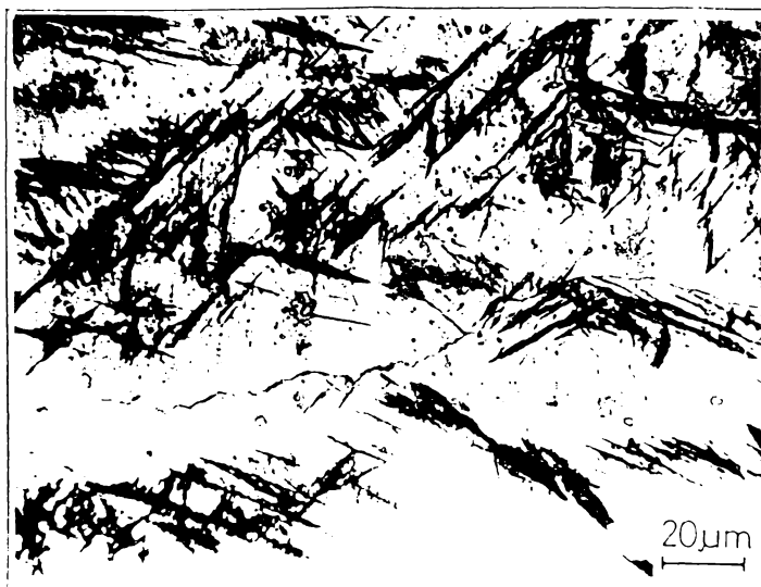
Figura 4.5.1 - Microstructura ZIT [Atac Nital 2%, 500x]
